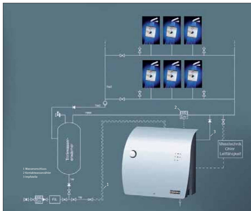
Bild 6: Einbindungsbeispiel AQUADES DOS I mit Chlor- und Leitfähigkeitsmesstechnik
